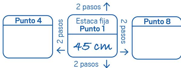
3) Ya anotada la profundidad de la estaca fija (Punto 1), darás 2 pasos en la misma dirección en que ingresaste y con la estaca móvil, medirás la profundidad de nieve en ese punto y lo anotarás en el recuadro del Punto 2. Luego darás nuevamente 2 pasos en la misma dirección y anotarás los resultados en el recuadro del Punto 3.
