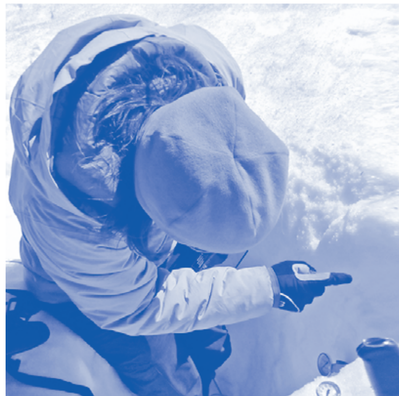
Esquema para aplicar el test de dureza de nieve. Recuerda realizar el experimento de manera horizontal (de lado).
